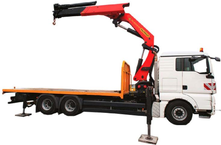
▲ CAMIÓN GRÚA CON PLATAFORMA DE 6 METROS Y GRÚA PALFINGER PK 27000.
